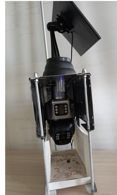
Capcana digitală pentru sistemul informațional de protecție a plantelor.
