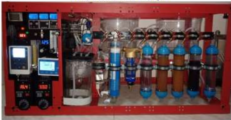
Instalație portabilă pentru testarea materialelor filtrante și a tehnologiilor de potabilizare a apelor naturale
