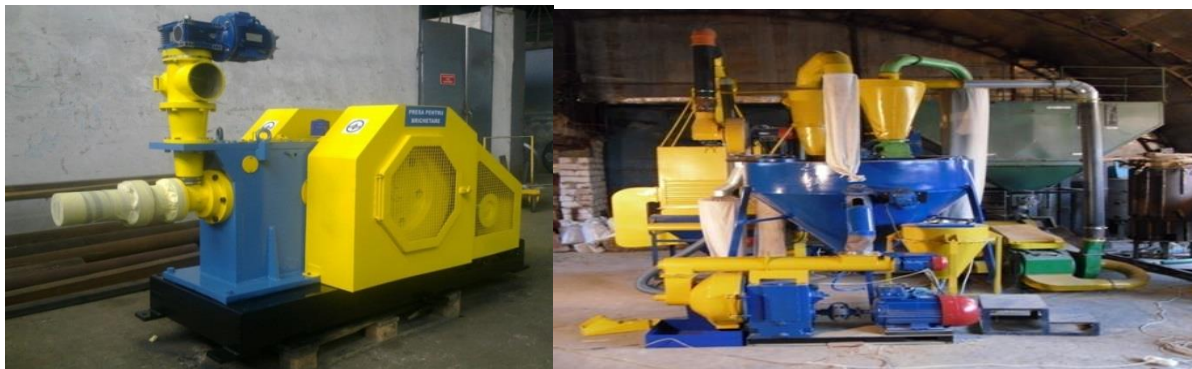
Fig. 23. Utilaj de brichetare și peletizare, producător „Mecagro”, productivitate 400–750 kg/h
