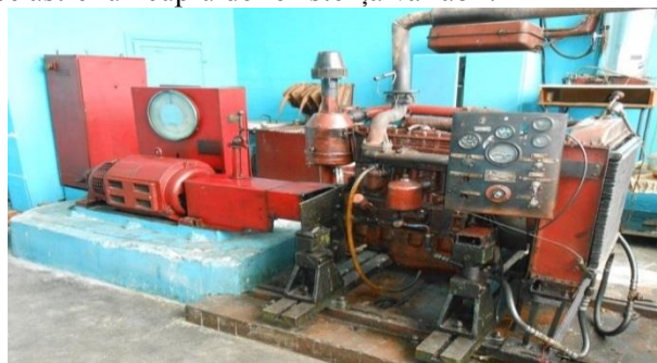
Fig. 1. Stand pentru încercarea motorului KI 13638 GOSNITI.
