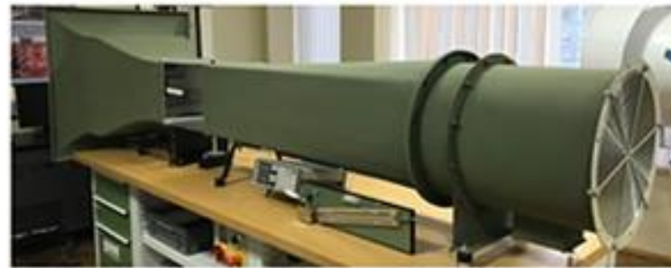
Testarea segmentelor de pale aerodinamice în tunelul de vânt
