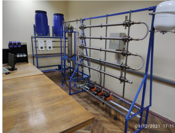
Instalația de termoficare hibridă în baza pompei de căldură ecologice.
